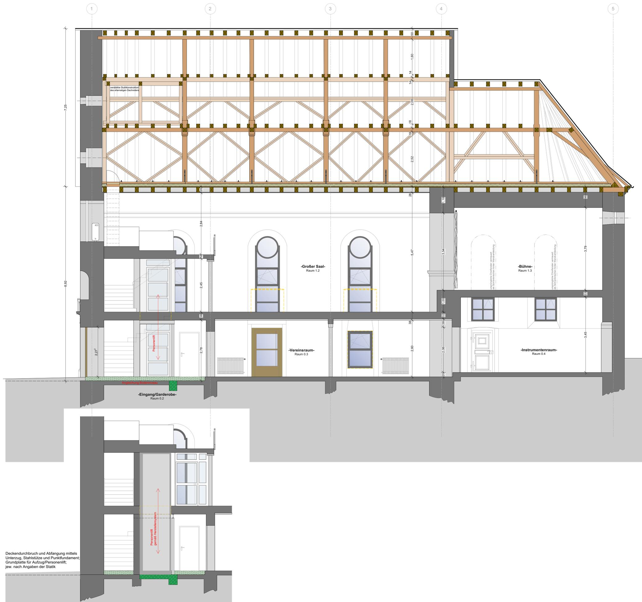
Deckendurchbruch und Abfangung mittels Unterzug, Stahlstütze und Punktfundament; Grundplatte für Aufzug/Personenlift; jew. nach Angaben der Statik
